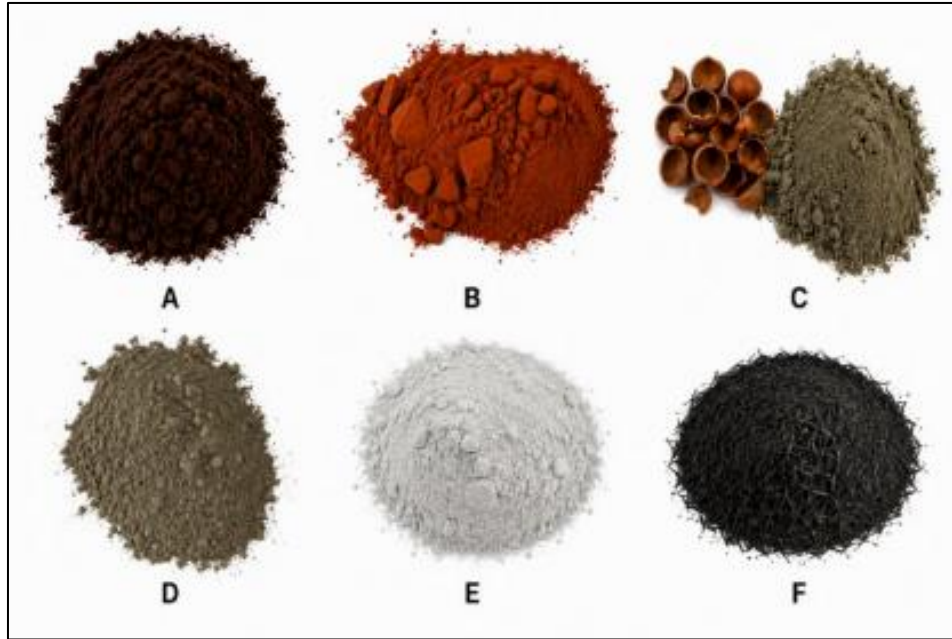
Figure 1 Materials used: (A) Pumice (B) Brick Dust (C) Hazelnut Shell Ash (D) Aluminous Cement (E) Blast Furnace Slag (F) Rice Husk Ash
